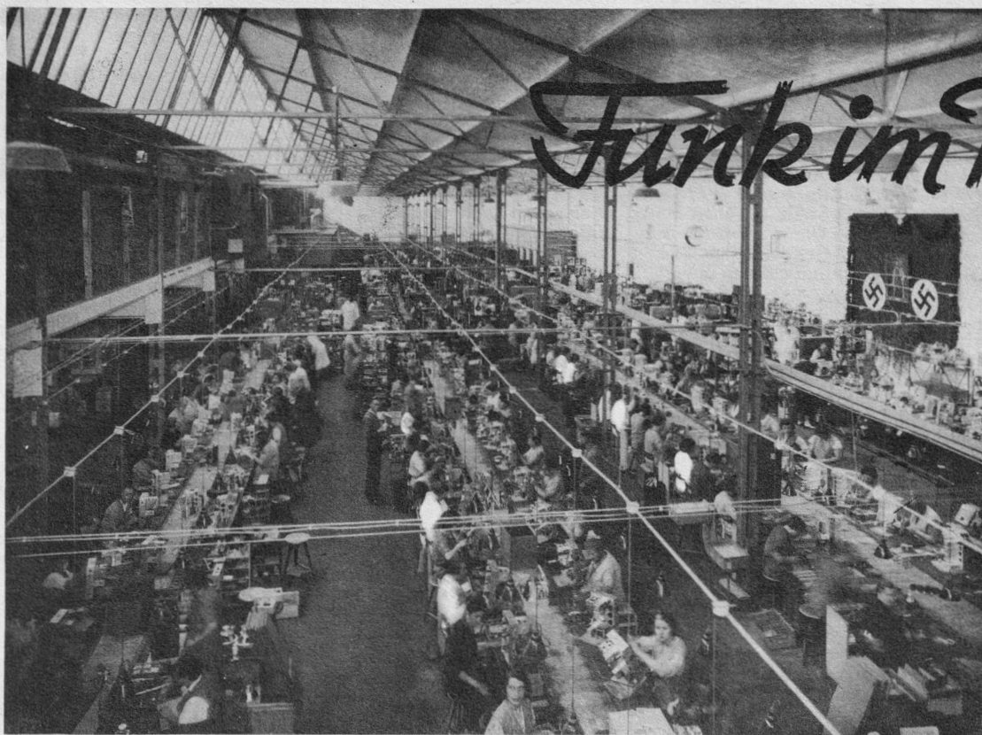
So sieht's in einer modernen Rundfunkempfängertabrik aus, wenn Hochbetrieb herrscht. Drei Fabrikationsbänder laufen der Länge nach durch die Halle, zu beiden Seiten sitzen die Arbeiter und Arbeiterinnen, um ihre Handgriffe an dem vorbeiziehenden Stück auszuführen. Werkphoto Lorenz.
